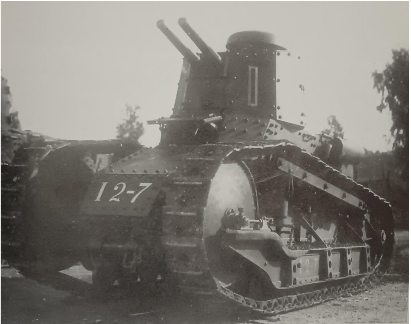
FIAT 3000 A armato con 2 mitragliatrici FIAT 14/35 cal. 8 mm e con i longheroni rinforzati
