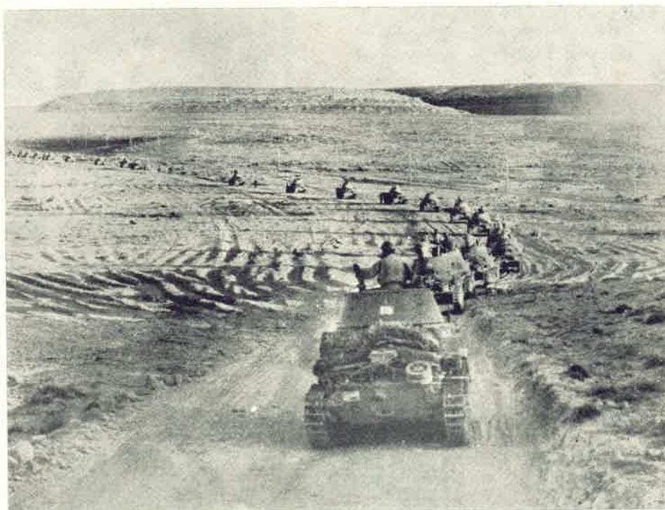
Carro armato M 13/40, interamente progettato e costruito in Italia. Con lo scafo derivato da quello dell'M 11/39, pesava circa 14 tonnellate. I primi 15 esemplari furono consegnati nel luglio 1940. Era armato di un cannone da 47/42, montato su torretta girevole, con alzo a telescopio e brandeggio idraulico; tre le mitragliatrici da 8 mm.: 1 in torretta, 2 in casamatta. Velocità massima: 32 km/h. Equipaggio: 4 uomini. Fu il carro base delle nostre unità corazzate in Africa Settentrionale. Dal carro M 13/40 derivarono, l'M 14/41 e l'M 15/41 con motore potenziato a benzina. In una fotografia storica: il LI battaglione carri M 13/40 in marcia nel deserto dell'Africa Settentrionale. Comandato dall'eroico ten. col. Zappalà, medaglia d'oro alla memoria, il reparto si coprì di gloria nella dura campagna di guerra.
