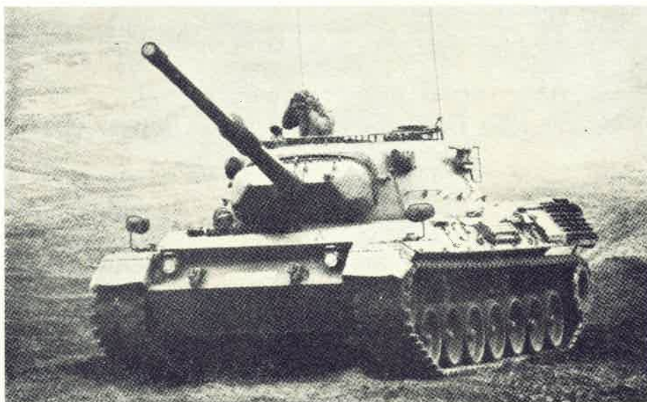
Carro armato tedesco « Leopard », armato di un cannone da 105 e 2 mitragliatrici. Nel 1972 si è iniziato a dotarne i reparti carri italiani.
