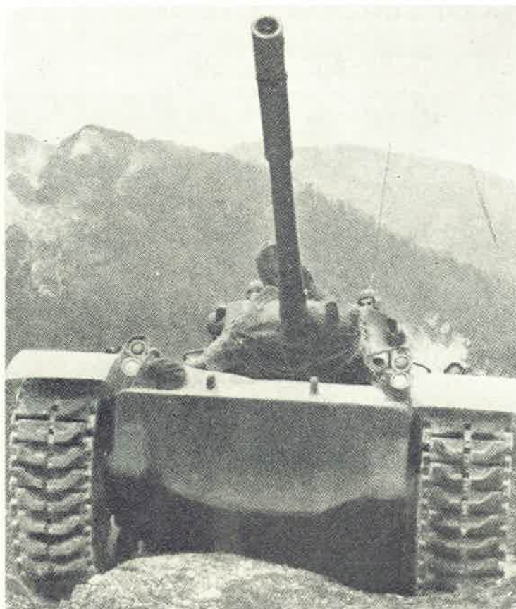
Carro M 47 « Patton », di costruzione americana (1951). Arma- mento: 1 cannone da 90 mm. e 3 mitragliatrici. Nel 1952 ne fu- rono dotati i reparti carri italiani.
