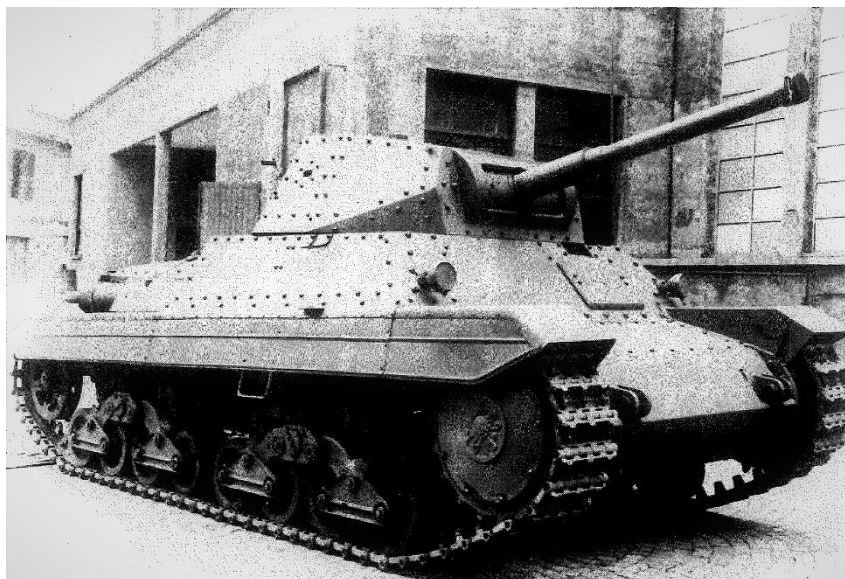
Il P 26/40 nella sua versione definitiva. Da notare la corazzatura inclinata per l'influsso del T34 russo
