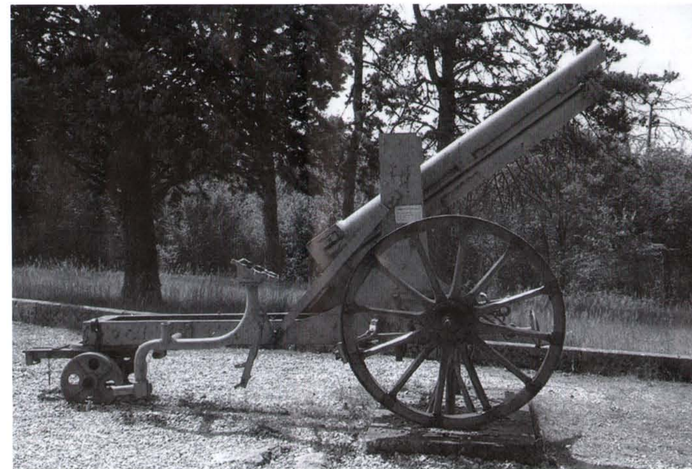
Un cannone 77/28, delle prime serie, realizzato nel 1907 per l'esercito austro-ungarico dalla Skoda ed estensivamente impiegato nella Prima Guerra Mondiale. Come preda bellica, dopo il 1918 alcune centinaia di queste armi passarono all'esercito italiano che, trasformato il calibro da 76,6 ad 80 millimetri, lo assegnò alle truppe coloniali. La colonna italiana distrutta dagli inglesi il 16 giugno 1940 a Gabz - Gdeif - Ghirba comprendeva una batteria di 77/28 agli ordini del S. tenente Raffaele Bonanno.
