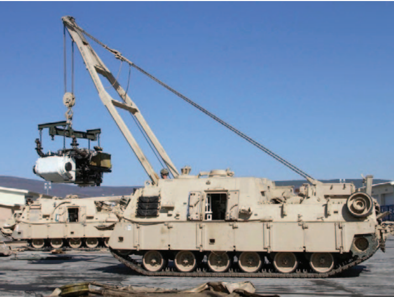
Un M88A2 mentre movimentava il blocco motore di un carro M1 Abrams www.psmagazine.army.mil/News/Article/2290759/m88a2-recovery-vehicles-new-brake-modulation-valve/
