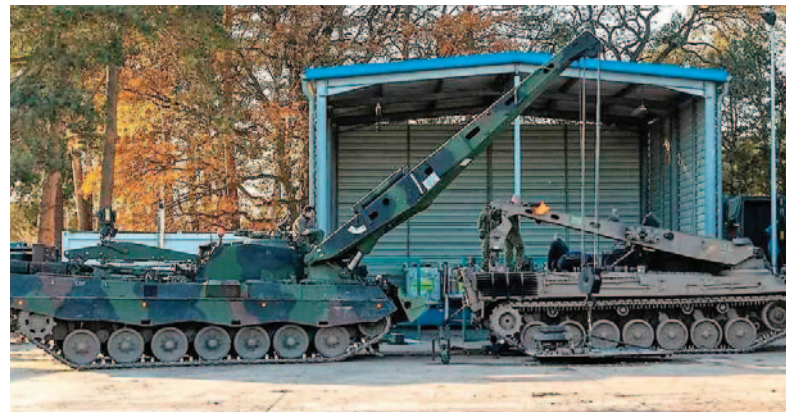
In questa immagine sono evidenti le differenze in termini di dimensioni totali e di dimensioni del braccio della gru tra il Bergepanzer 3 Büffel su scafo Leopard 2 (a sinistra) e il Bergepanzer 2 su scafo Leopard 1 (a destra).
