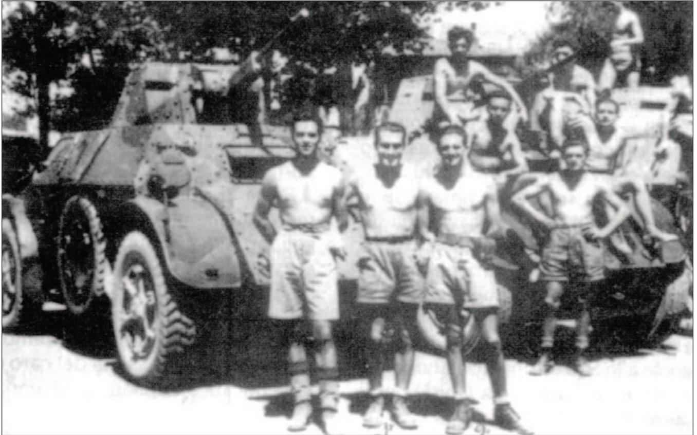
Le uniche tre autoblasteri AB41 della sezione AB40 del IX Reparto d'Assalto del Corpo Italiano di Liberazione; i veicoli sono mimetizzati secondo lo schema tipico del periodo, un fondo giallo sabbia con macchie marroni e verdi, e la seconda macchina monta pneumatici del tipo "Libia" (Pignato).
