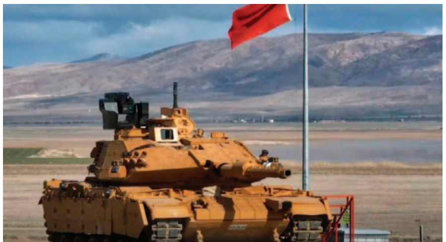
M60T1, la foto consente di apprezzare le modifiche introdotte rispetto all'M60T della foto precedente
