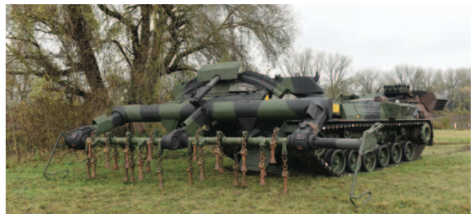
Flagelli rotanti Minenräumpanzer Keiler su scafo M48A2 Patton
