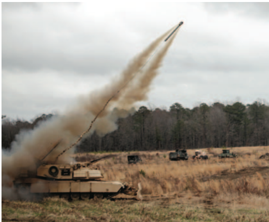
Lancio da M1150 ABV di un linear charge system M58A3
