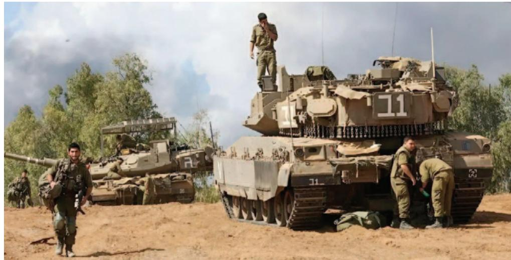
Oltre al Merkava in primo piano, dotato di sistema anti-missili ATGM, e di "Shulamit hairs", è visibile in secondo piano un altro Merkava con una griglia anti-droni sopra il cielo di torretta.
