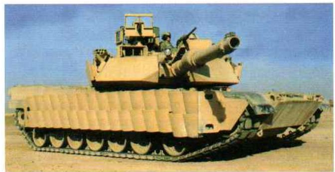
Il sistema TUSK (Tank Urban Survival Kit) del carro M1A2 Abrams statunitense comprende, oltre alle corazzature reattive aggiuntive e alle griglie blindate posteriori a protezione del propulsore, una torretta a controllo remoto e varie apparecchiature elettroniche che potenziano la visione e il controllo del tiro. (US Army)
