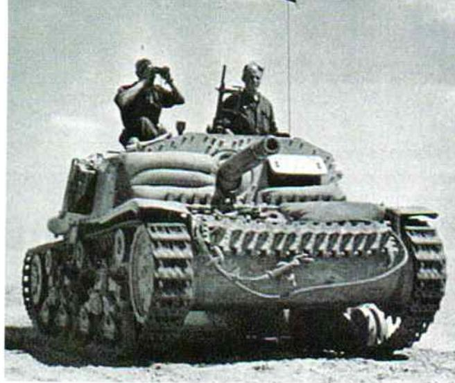
Il semovente da 75/18 era un obice autopropulso realizzato sullo scafo del carro armato M13/40. Fu molto impiegato in Africa settentrionale a partire dalla primavera del 1942. Per aumentare la protezione della corazzatura venivano collocati all'esterno sacchi di sabbia e spezzoni di cingolo di ricambio; una soluzione di ripiego, questa, adottata anche da altri eserciti.
