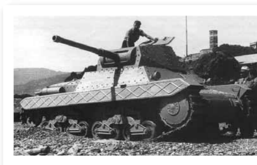
Il prototipo del P 26/40 in un campo prove. Notare le grembiature laterali modificate.
