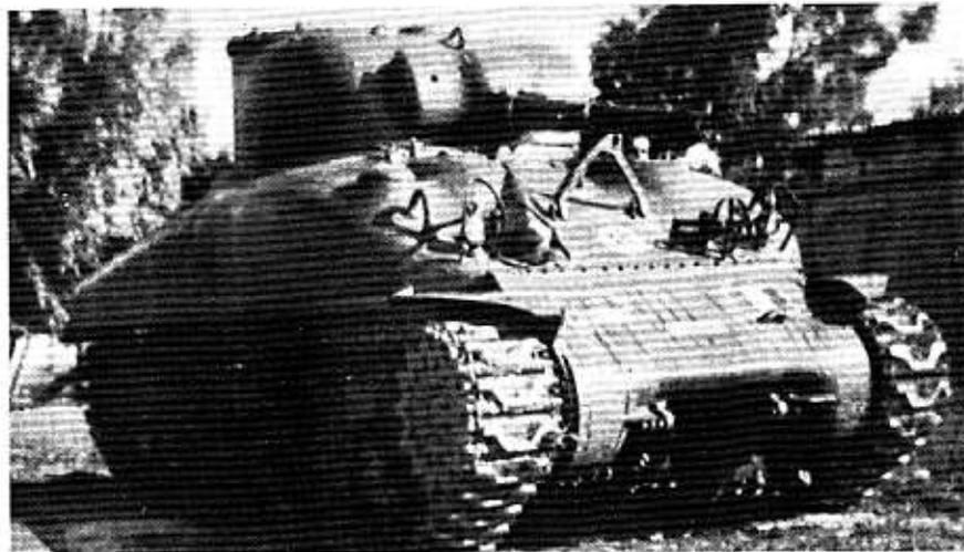
Carro armato M. 4 Sherman. Costruito dagli Stati Uniti nel 1941, era armato di un cannone da 75 o di un cannone da 76 lungo (per l'artiglieria corazzata di un obice da 105) e 3 mitragliatrici. Ne furono dotati i reparti carri italiani dal 1948 al 1952.
