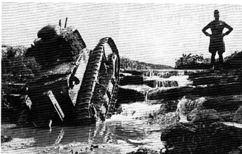
In alto: un carro « Fiat 3000 » nel superamento di un torrente. In basso: un carro « L 3 » schizza dall'autocarro in movimento.
