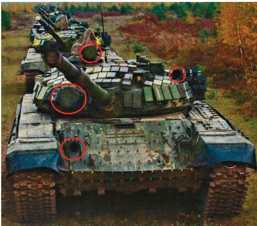
I quattro proiettori infrarossi montati su un carro russo T90
