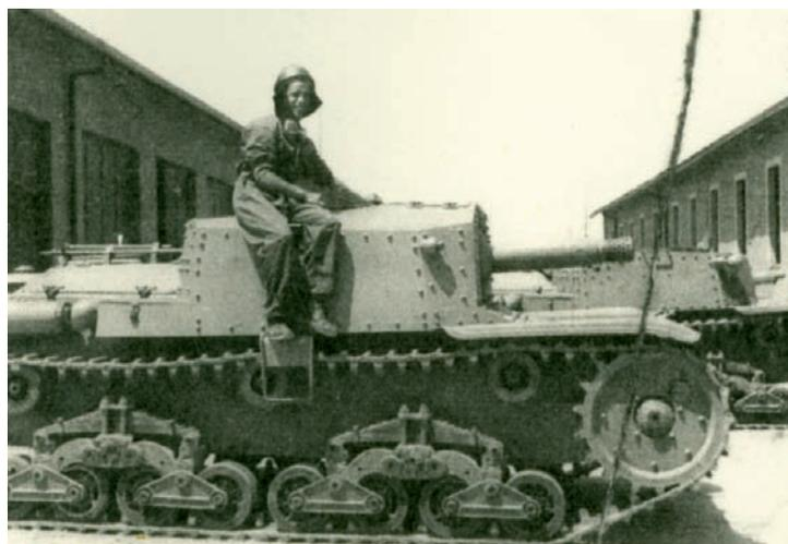
**Carlo Volonté in posa in due belle immagini sul semovente M13/75. Particolarmente idoneo per il tiro contro carri il mezzo era dotato di obice da 75/18 e da una mitragliatrice da 8 mm controaerei. Aveva velocità di 35 Km/h. e un'autonomia di 200 km.**
