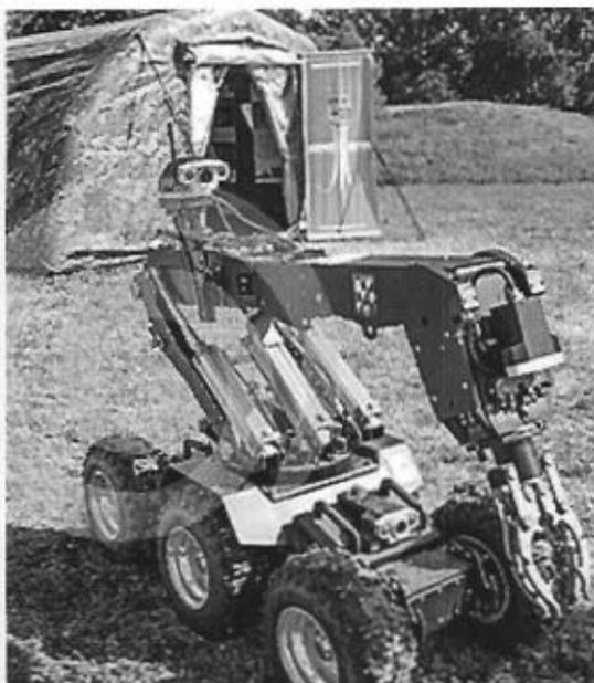
Drone per rimozione ordigni.
