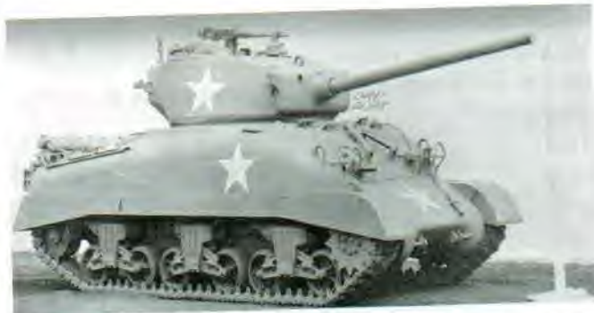
La versione M4A1 dello Sherman, qui con cannone da 76 mm, era caratterizzata dallo scafo superiore in un pezzo unico realizzato per fusione, così come la prua, lo scudo del cannone e – come già detto – la torretta. (Library of Congress, USA)
