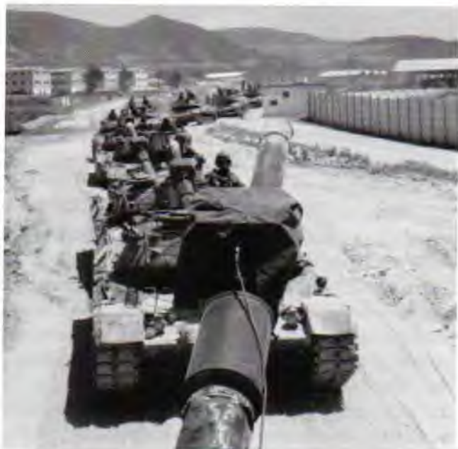
Carrì in colonna per inizio attivita' di esercitazione. Notare il simulatore di sparo (Hoffmann-Werke) montato sulla bocca da fuoco.
