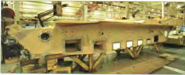
Lo scafo di un M1A2 Abrams pronto per l'assemblaggio con il resto delle parti. (Daniel Terdiman/CNET/CBS)
