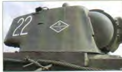
Il sovietico KV-1 impiegato nella seconda guerra mondiale possedeva una controcarena (a sinistra) molto pronunciata. Si noti la torretta realizzata mediante fusione. (Dmitry Kiyalkin/Primeportal)
