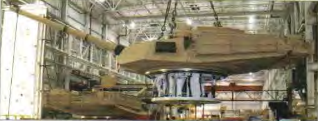
La torretta di un M1A2 Abrams con il sottostante cesto; si nota anche l'anello per la rotazione. In secondo piano, a sinistra, un'altra torretta ma priva di cesto, con ben visibili i contenitori esterni detti "portabottino". (General Dynamics Land Systems)
