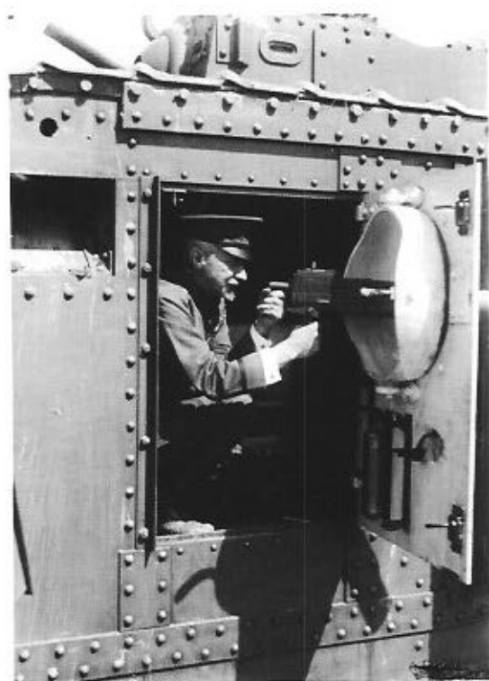
Un particolare della postazione della mitragliatrice installata sul portello
