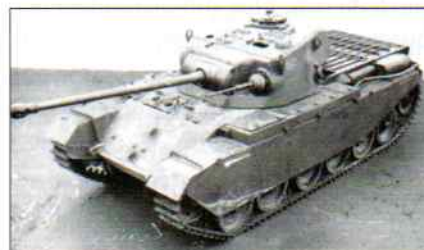
Il prototipo del Centurion. Notare il cannoncino da 20 mm poi abolito.
