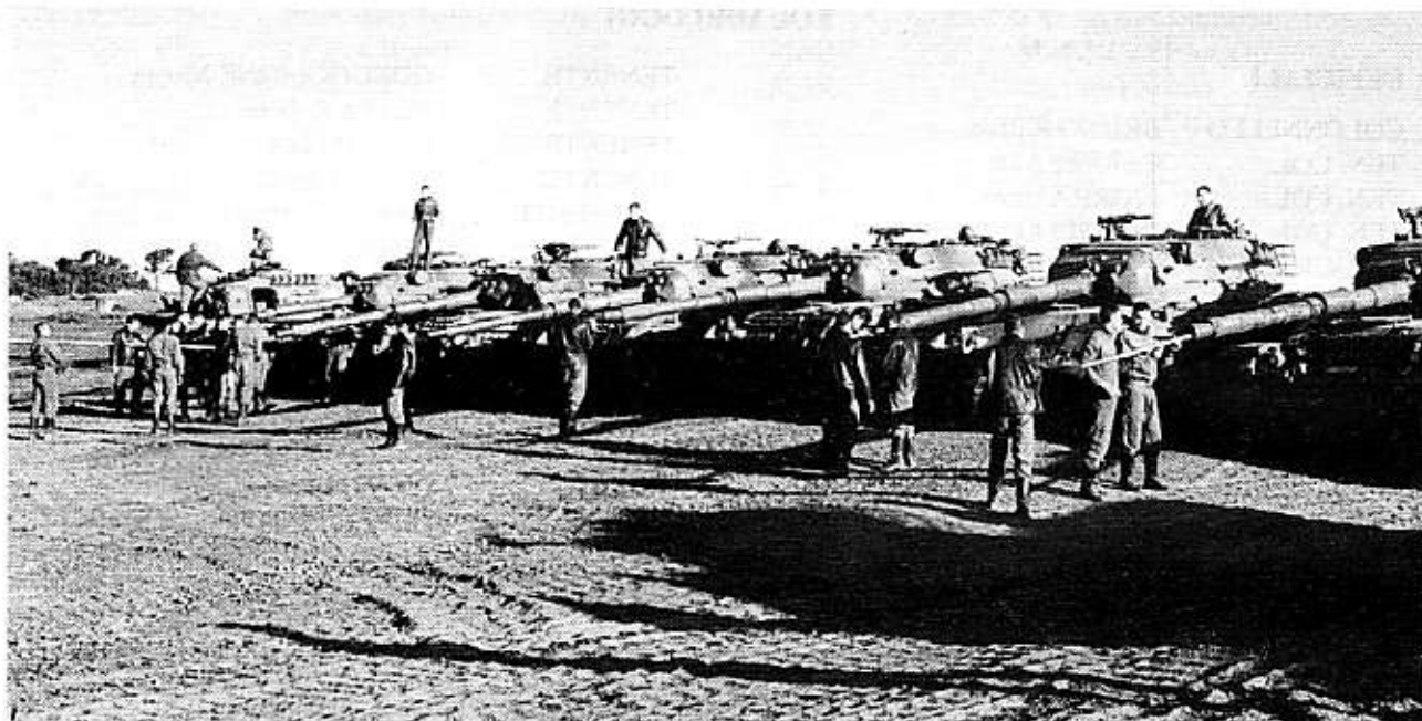
4° Reggimento. Manutenzione carri. (Operazioni di scovolgimento prima dell'esercitazione Sirio '96).
