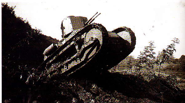
Mod. 21 - Fiat 3000 A. Carro armato del 1° Reggimento carristi. Successivamente fu costruito con un cannone da 37 mm (3000 B), anziché 2 mitragliatrici in torretta (Mod. 30).
